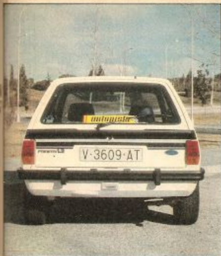
Como en los demás Fiats, por desgracia, la protección ofrecida por los parachoques no pasa de simbólica.
